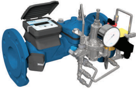
SKV6030 : Uzaktan Solenoid Kontrollü Mekanik Basınç Ayarlı Sayaçlı Kontrol Vanası
